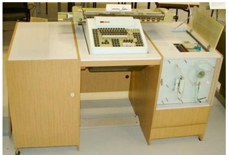
Buchungsautomat Ascota 170-LB mit Lochbandtechnik
