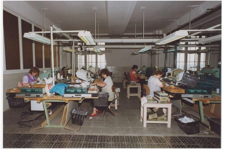
Montage Leitungsschutz - Schalter (Montage 1)
